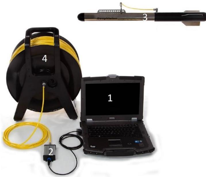
**Figura 1: Equipo Sonar Deep Vision dual DE3468D**
